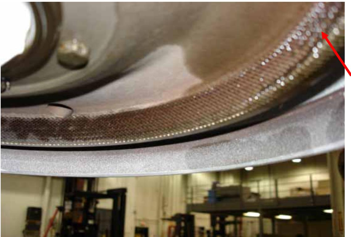
圖 3.8 軸封蜂巢結構有新的磨擦痕跡箭頭所指處
