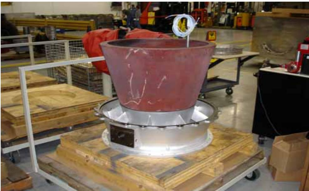
圖 2.9 動力渦輪及尾錐管
