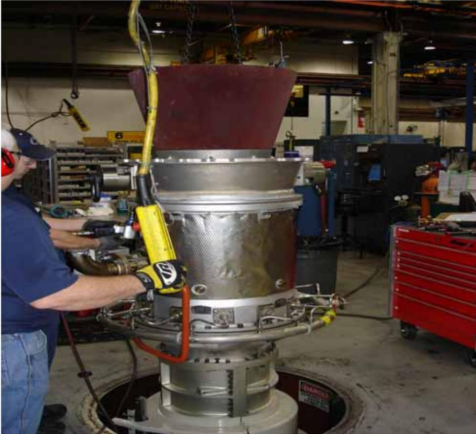
圖 3.7 發動機下測試台再次拆解檢查
