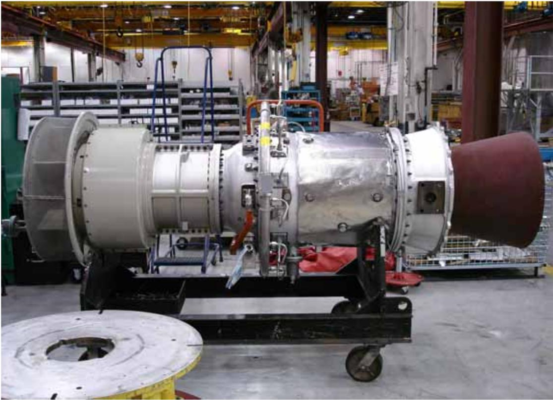
圖 3.5 發動機組裝完成
