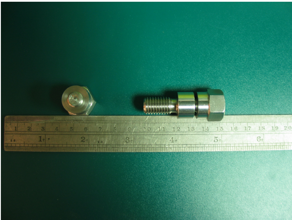
圖十二、汽封片保護環固定用特製螺栓(2)。
