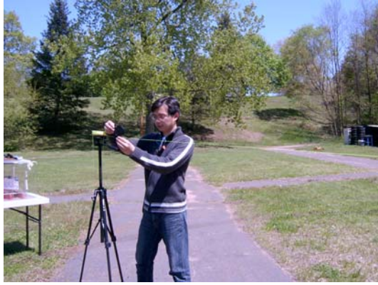
圖 7、量測彈道垂直方向的角度。
