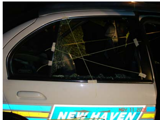
圖 6、擇取數條裂痕並以拉線方式重建裂痕交錯位置，即為可能的彈孔中央位置。
