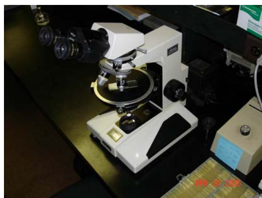
圖 67、偏極光顯微鏡外觀
