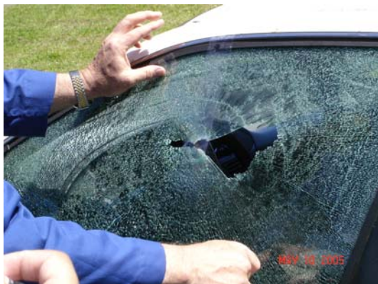
圖 5、觀察彈孔周圍殘餘玻璃上輻射狀裂痕。
