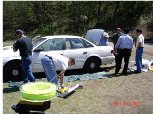
圖 2、細繩一端固定於延伸桿，另一端向彈道來源方向延伸。
