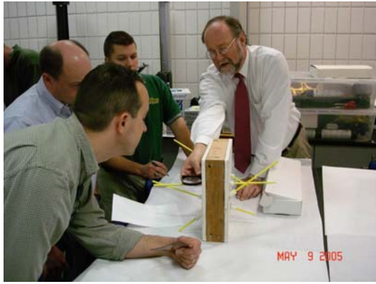
圖 1、以延伸桿重建彈道方向。
