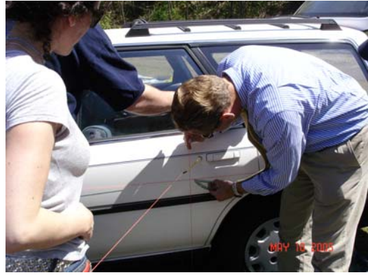
圖 8、量測彈道水平方向的角度。
