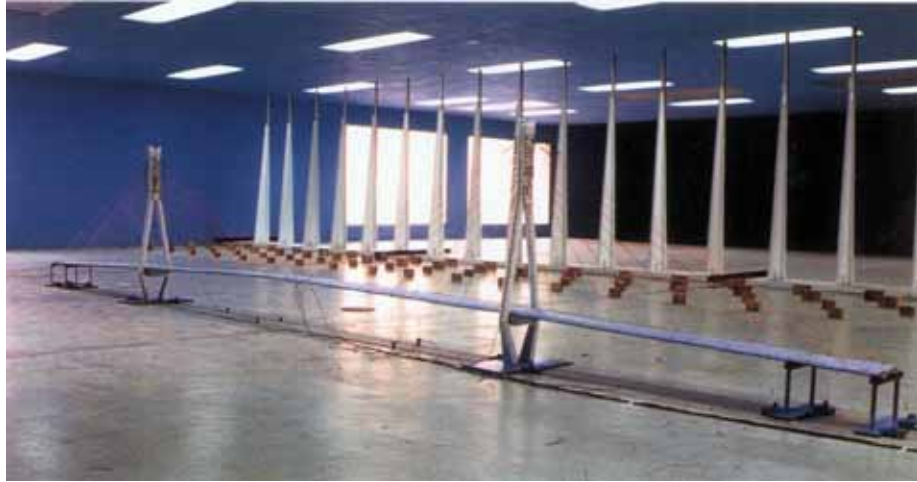
照片十四 大型風洞 TJ-3 做長跨距斜張橋風洞實驗
