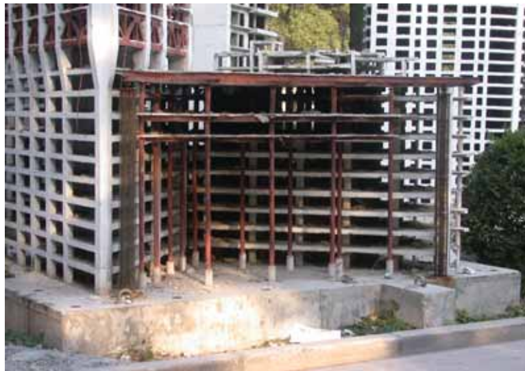
照片十二 振動台實驗後的縮尺模型之一
