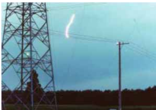
圖 15 配電線直接雷擊實驗
