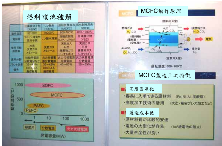
圖19 發電廠級熔融碳酸鹽型(MCFC)燃料電池原理特徵
