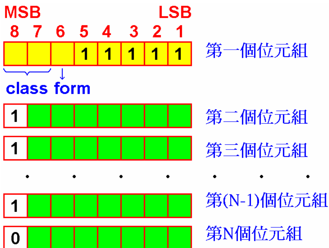
圖 C Type 的資料格式（長度不止一個 byte）
