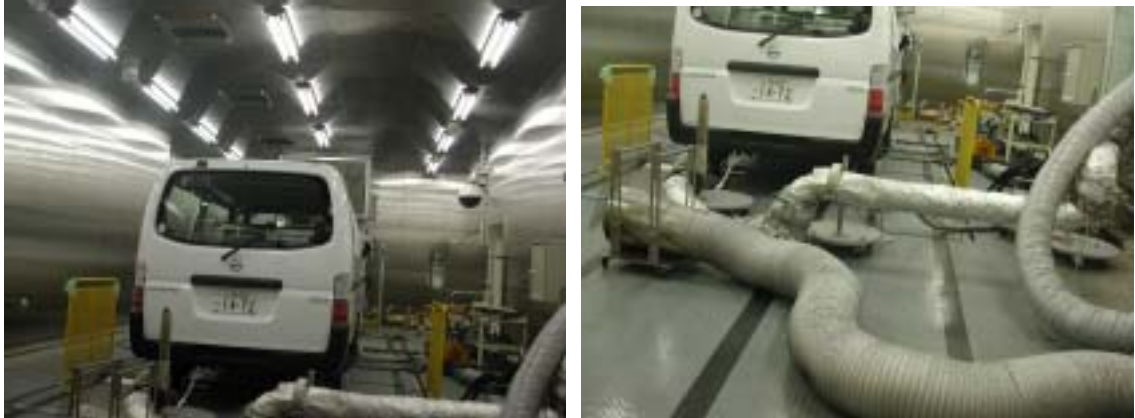
圖 22 日本國立環境研究所汽車排氣檢驗設施
