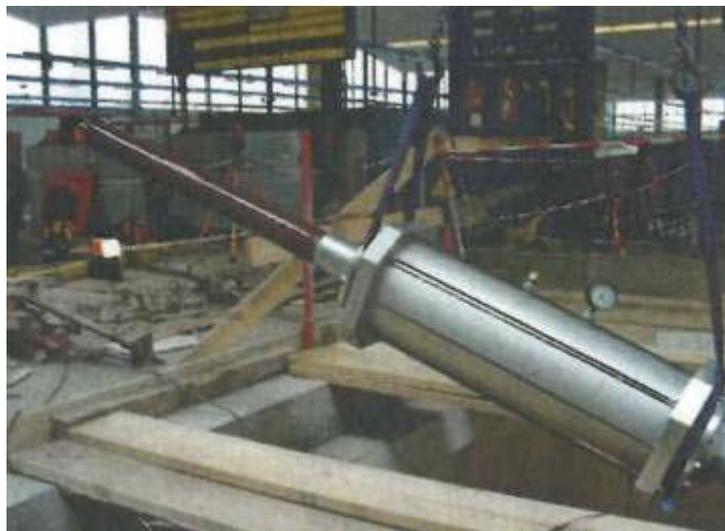
圖23 電纜測試終端匣組
