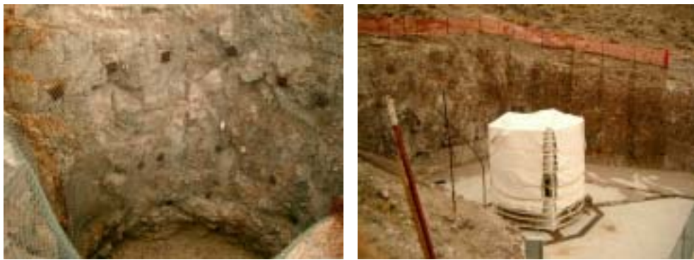
圖 5-19 開挖測繪（左）及現地原型加熱試驗（右）
