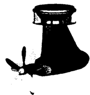
二重反転プロペラ式ポッド推進器 Podded Propulsor with Contra-Rotating Propellers
