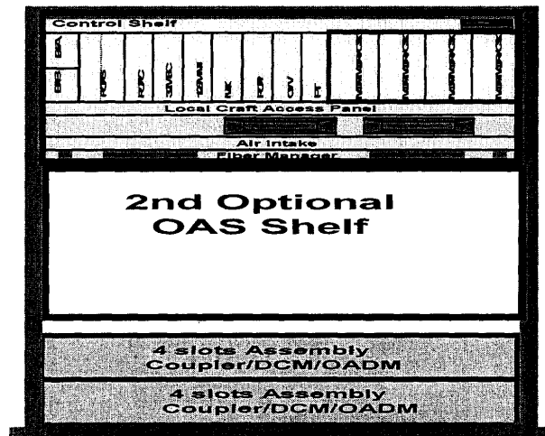
圖 3-5 光放大器機架(OAS) 結構圖
