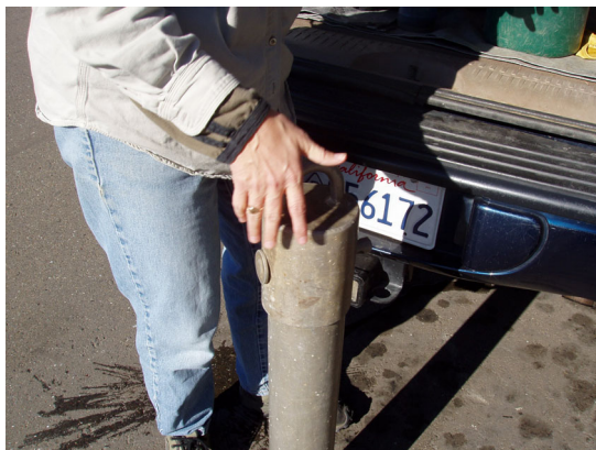
監測儀器外套不鏽鋼管加強重量利於河底固定
