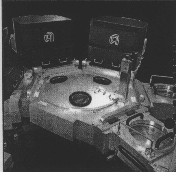
圖 26:美國應用材料公司所提供之下世代高密度化學氣象沉積電漿設備，可沉積多種薄膜而不需更換硬體，採用多組合腔體設計，晶圓固定座採用可更換靜電吸附式，屬高級 HDP-CVD 電漿機台，價格昂貴。
