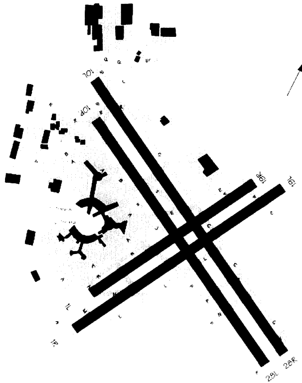
圖 4-3 機場空側及陸側系統
