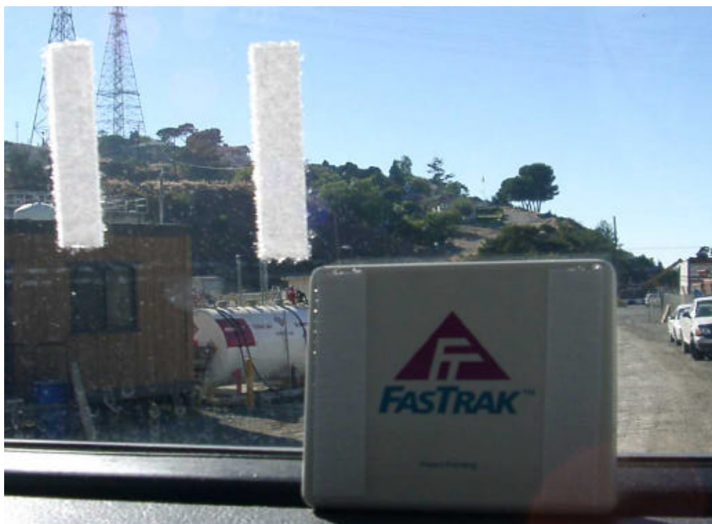
Transponder 置放位置，以及魔鬼沾貼布固定
