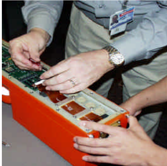
圖 3-15 注意排線接頭接觸情況
