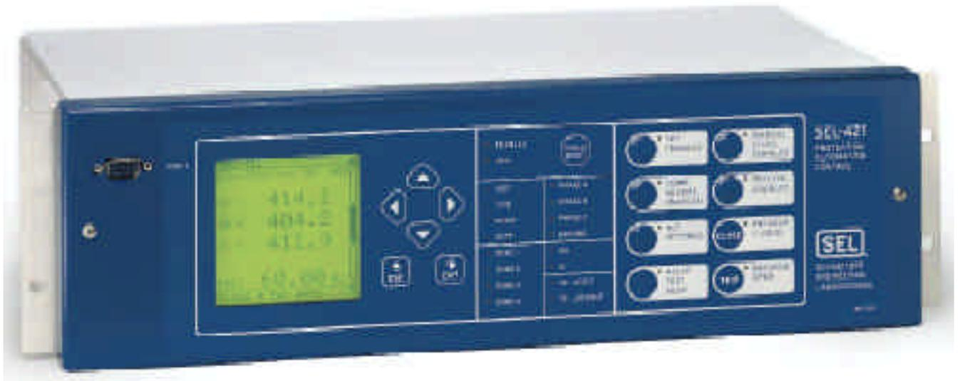
SEL-421 是 SEL 公司最新一代的輸電線保護測距電驛，該電驛整合了保護、控制、量測、自動化以及監視於一身，其摘要描述如下：
