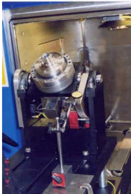
傾斜裝置定位精度測試
