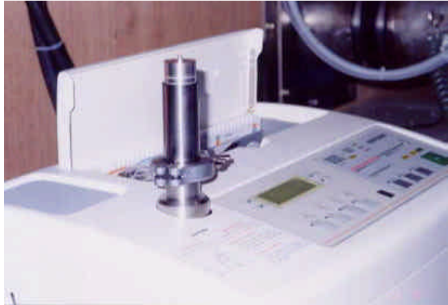
試焊件氦氣測漏
