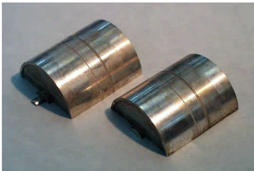
焊接試件焊道
