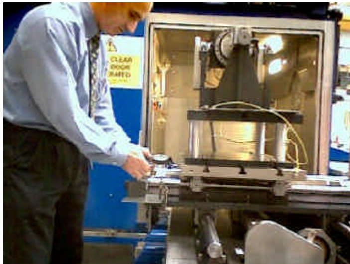
工作台定位精度測試
