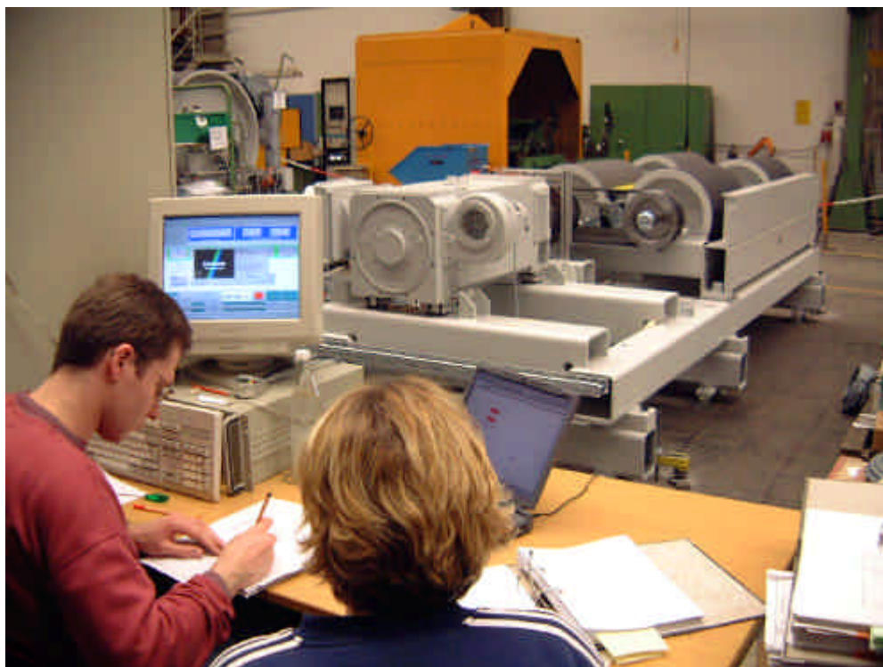
相片一 Schenck 小客車及摩托車兩用底盤動力計
