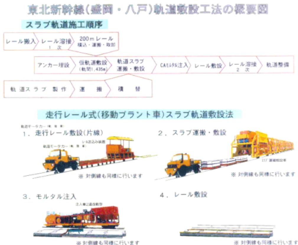
圖 4-4 框型版式軌道之鋪設工法概要圖
