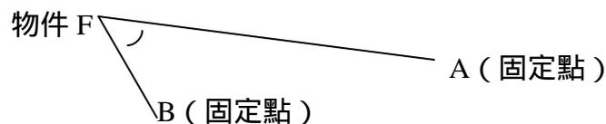
圖二：由 FA 及 FB 之距離及  $\angle AFB$  可更精確定位物件 F 之位置
