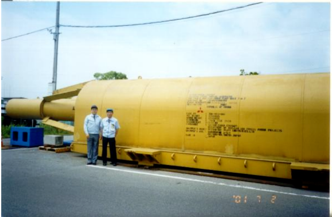
#2 發電機轉子 (Rotor) 在充滿氫氣壓力 Container 保護中待組裝。
