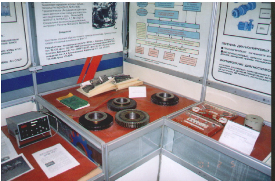
圖五：IMASH 機構研發完成的鎂合金材質航太用齒輪
