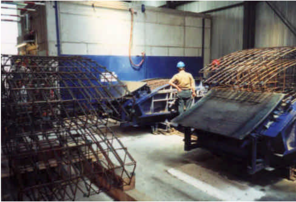
照片 5.4 襯砌環片製造工廠
