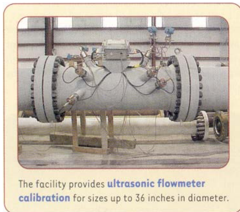
圖四 CEESI 之超音波計量設備
