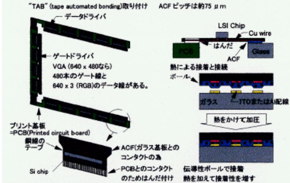
圖 20、TFT-LCD 模組及組裝工程
