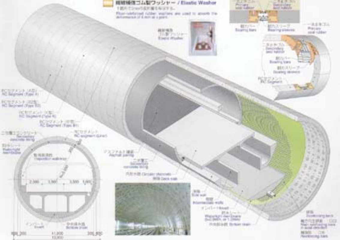
圖 8-1 : 東京湾穿越工程隧道剖面圖
