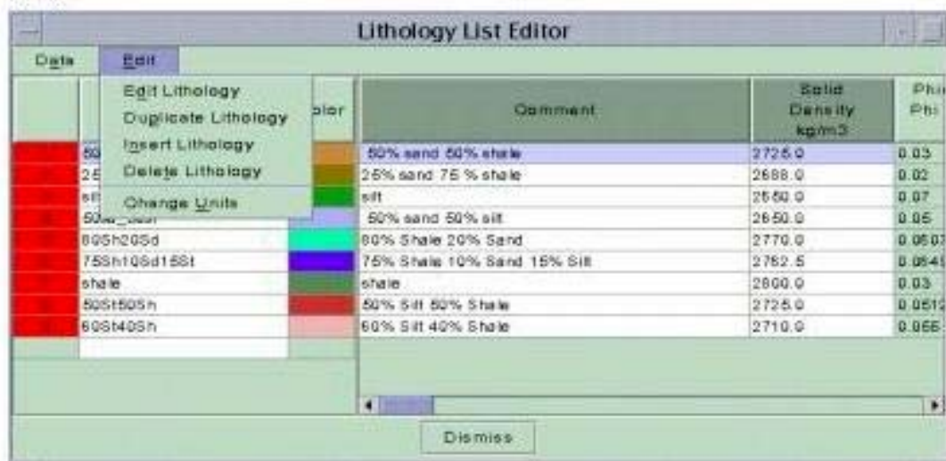
圖13 (a) TemisPack 2.6版可以混合二種岩性成為新的岩性。(b)2.7版此功已取消。
