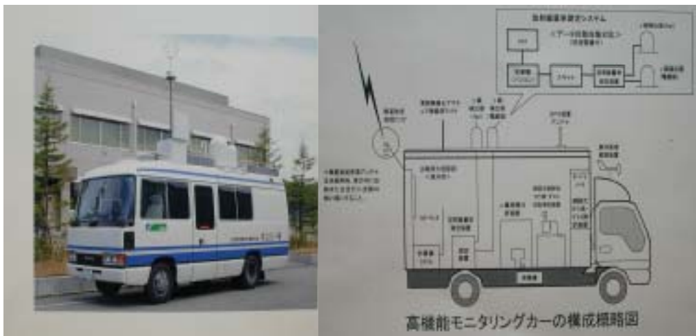
圖九、環境放射線測定車之外觀與設備配置概略圖
