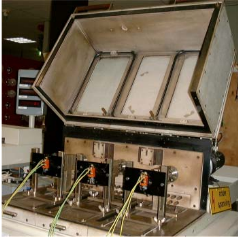
圖十 器具用開關耐久試驗設備（含溫度控制）
