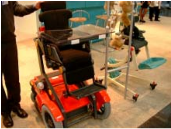
圖十四、兒童電動輪椅，此款電動輪椅可自如的升降高度，升至與一般人站立時同高，降至地面高度。
