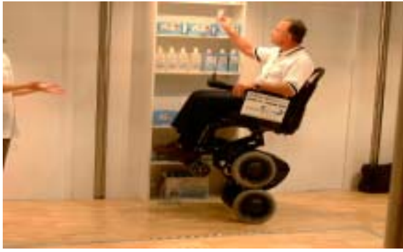
圖十、此輪椅的另一功能，藉由重力感測器，僅利用後輪即可平穩的站立，並可改變輪椅高度。
