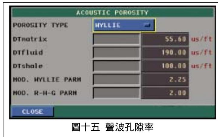
圖十五 聲波孔隙率
