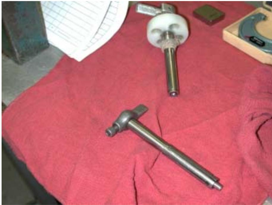
附圖五、外徑研磨夾治具
