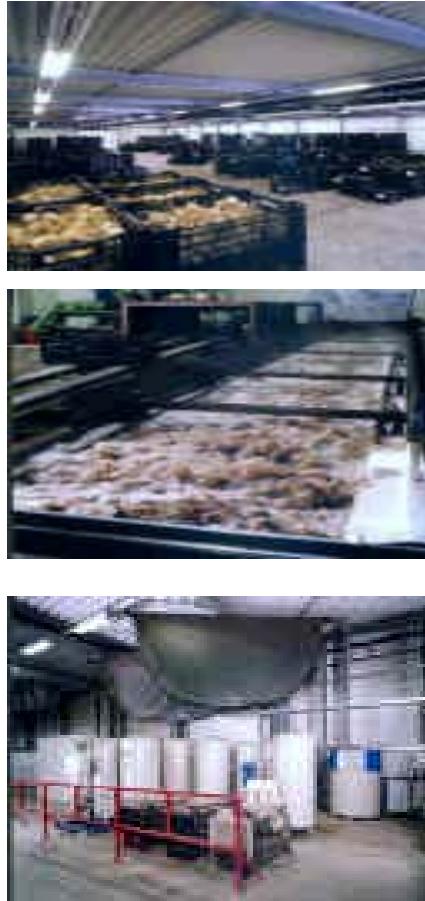
圖 1. 荷蘭百合種球之調製、儲藏系統 上：百合種球之採收、裝籃運送至調製場 中：自動覆蓋塑膠袋送交冷藏 下：ULO (Ultra Low Oxygen)長期儲藏
