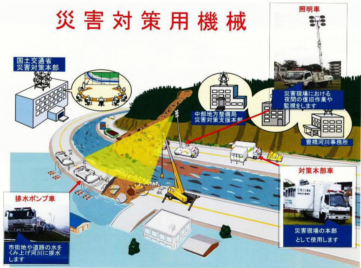
圖60 靜岡河川事務所災害對策使用設施及操作示意圖
