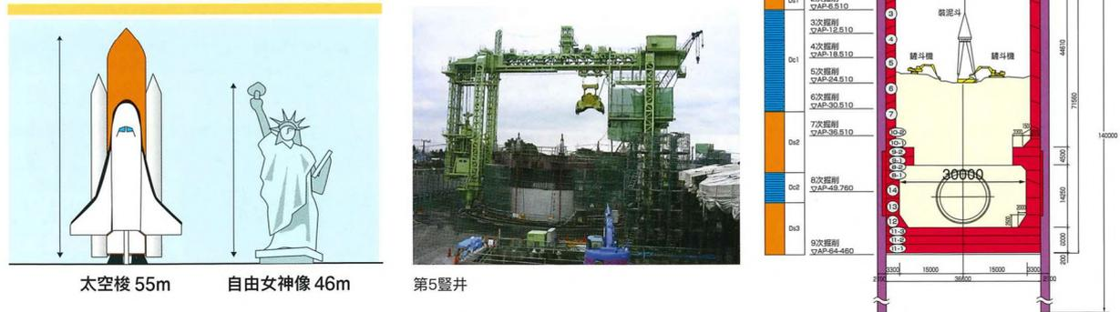
圖33 放水路5座豎井各項參數、豎井剖面及施工示意圖
