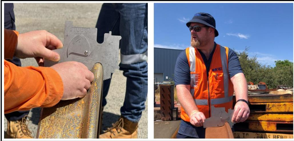
圖 3-10 操作鋼輪磨耗尺
