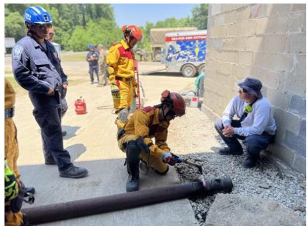
圖 15 熱切割(油氧切割)破壞體驗操作
