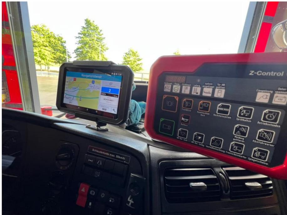
圖 18 消防車輛導航定位設備
