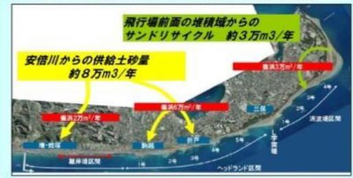
健全な流砂系の確立に向けた適正な通過土砂量(目標)
