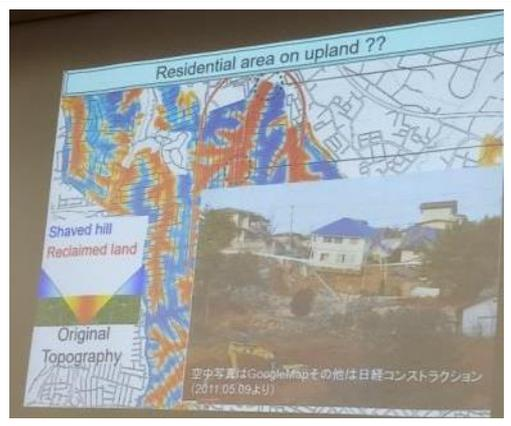
簡報: 都市開發常挖高地填低地並蓋房子在填土區上，地震來時填土區容易下陷造成災害
