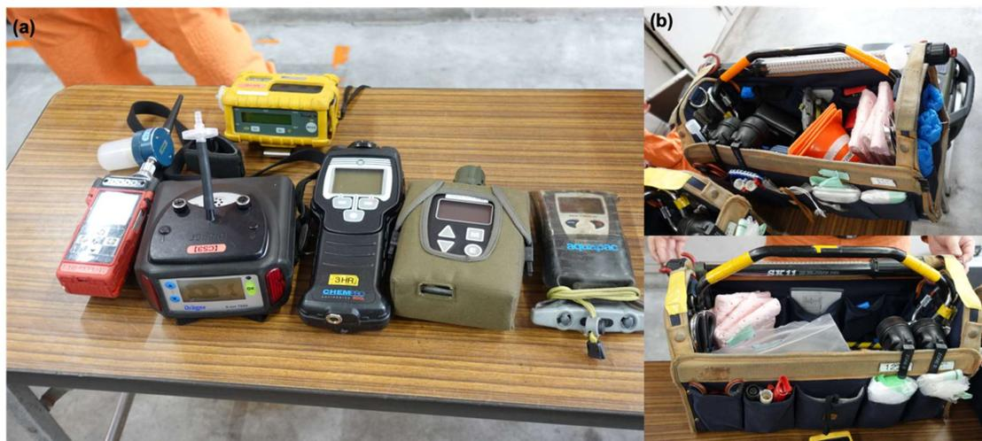
圖 29、第 3 消防救助機動部隊出勤時攜帶的偵檢儀器與箱子
