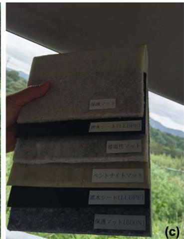
圖 16、土壤貯蔵施設示意圖與照片
