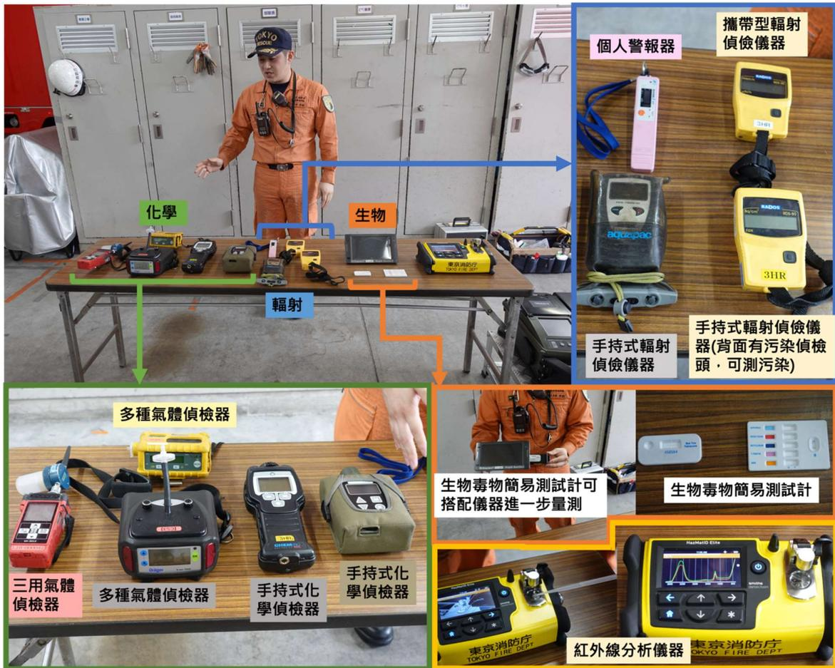
圖 28、第 3 消防救助機動部隊的偵檢儀器
