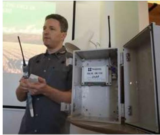
圖 22、Tevatronic 介紹該公司使用之感測器及資料傳輸模組
