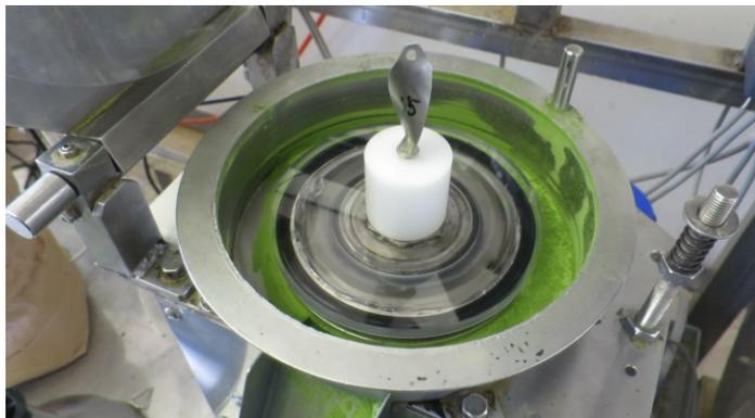
圖二十八、低溫磨粉機械冷卻系統構造。
