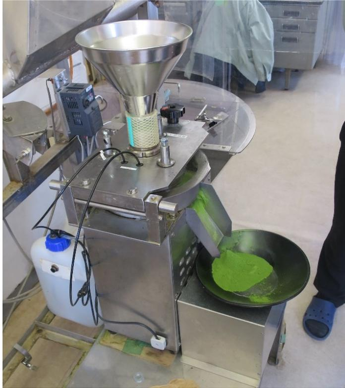
圖二十六、低溫磨粉機械作業情形。
