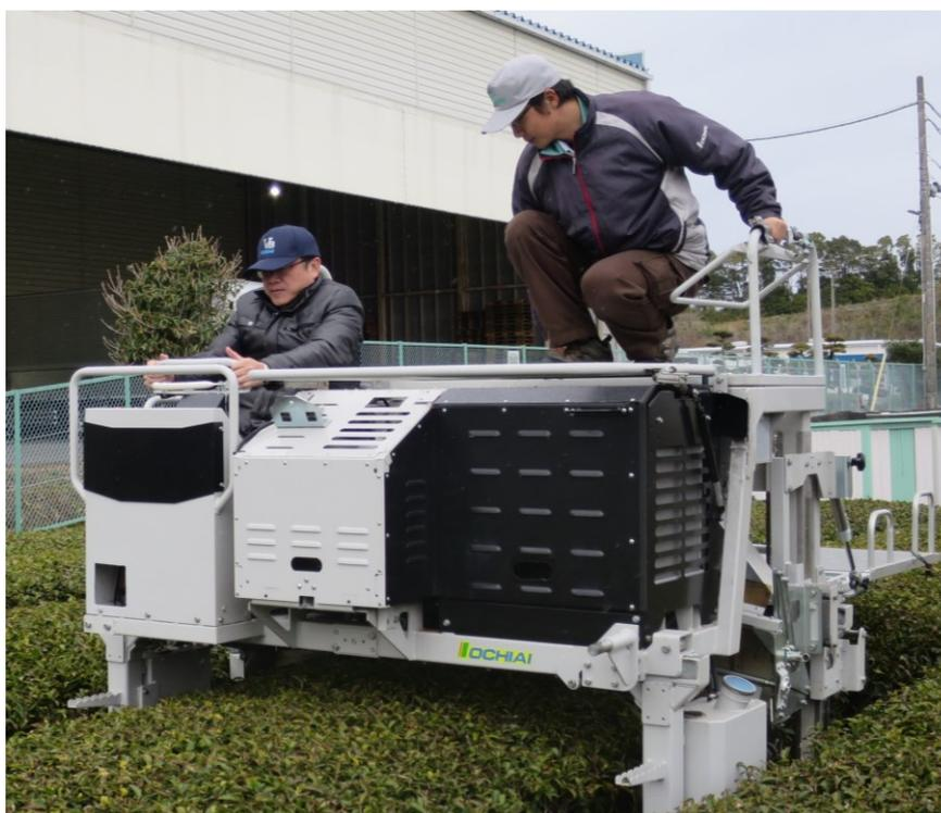
圖八、乘坐式採茶機作業情形。
