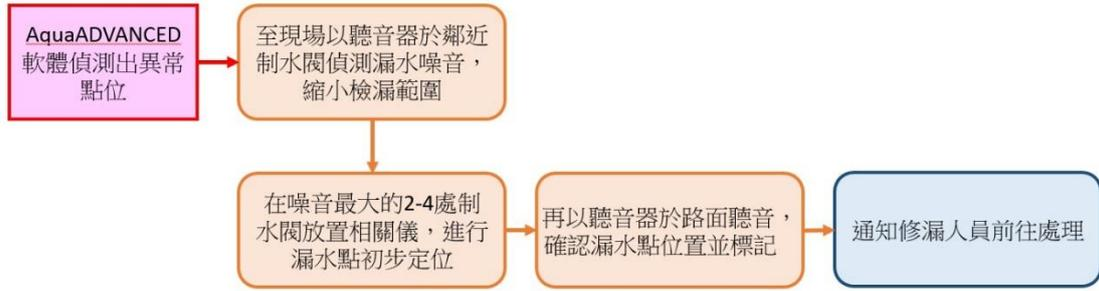
圖 4.4.2 SEPG 漏水檢測標準作業流程
