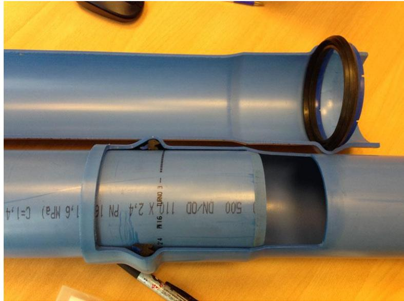
圖 4.2.6 可耐受高衝擊的塑膠管
