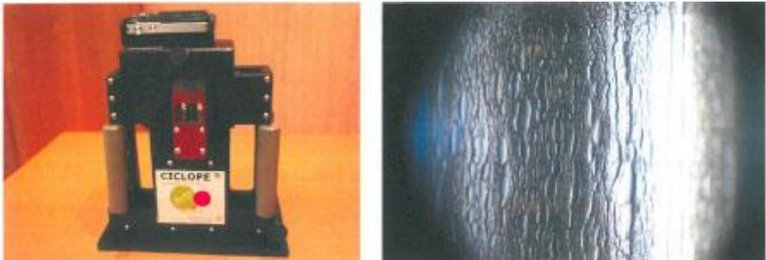
圖 4.2.7 檢測 PE 管狀況的儀器 CICLOPE
