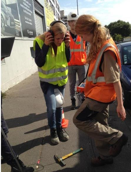
圖 4.4.5 以聽音器確認漏水點
