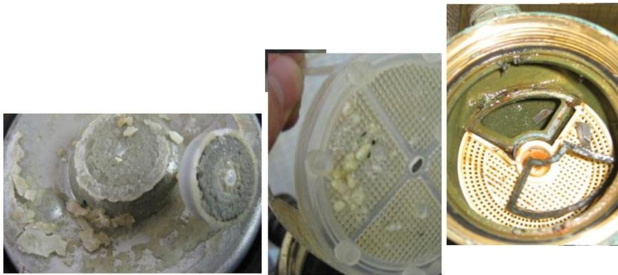
圖 4.3.2 水表內部堆積碳酸鈣、雜質及損壞情形
