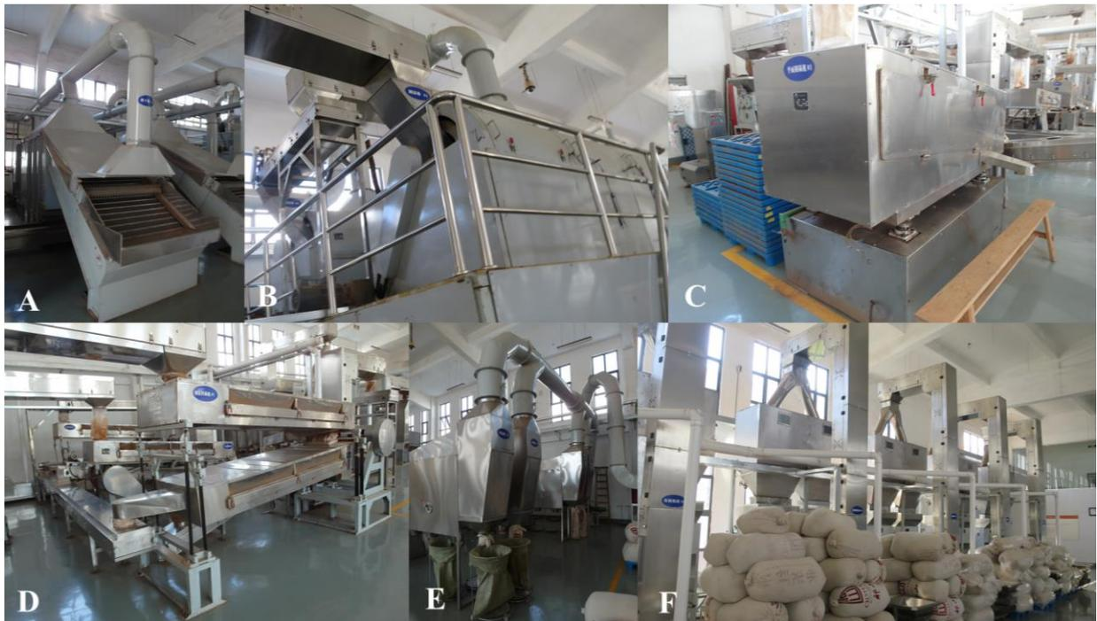
圖二、祁門紅茶製茶示範工廠—精緻生產流程。(A)將初製後的毛茶以乾燥機復火除去過多水分；(B)將乾燥後之毛茶以圓滾篩選機初步篩分外型大小差異；(C)平面圓篩機可依不同大小的篩孔區分不同粗細的茶葉；(D)雙層抖篩機用於茶葉分長短、粗細作業和分離取料；(E)風選機用於依茶葉的重量大小不同進行分檔定級；(F)分篩後的毛茶進入挑梗機組去除碎屑及雜物。
