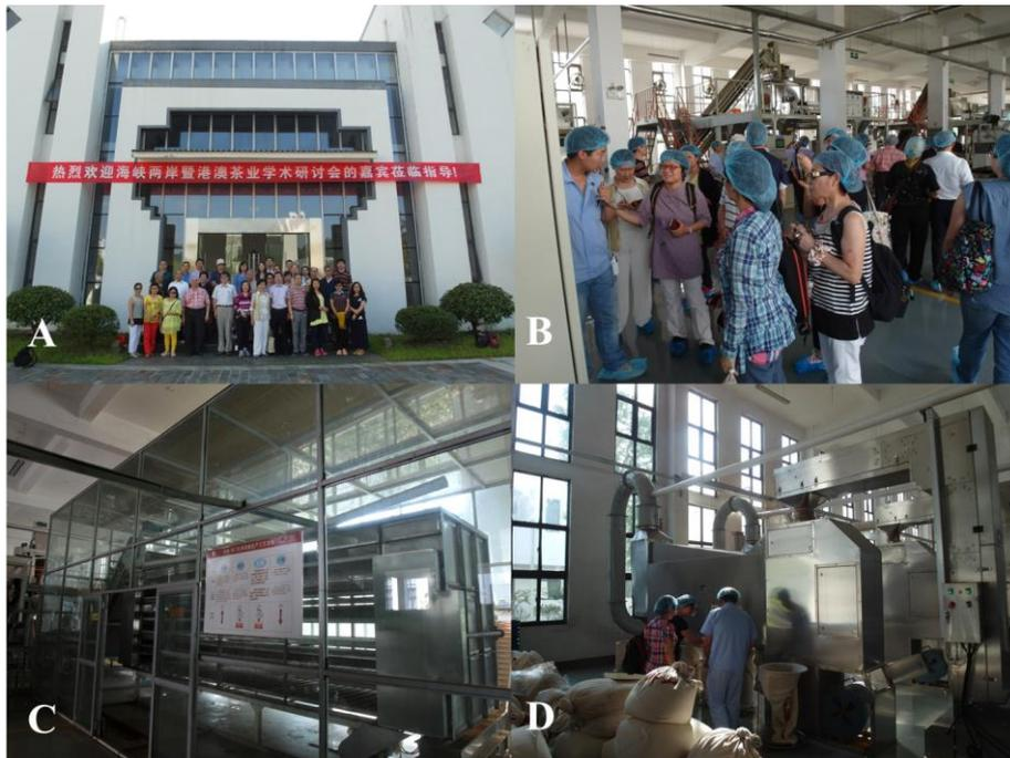
圖十二、祁門紅茶製茶示範工廠。(A)與會來賓於園區內合影；(B)製茶人員為來賓介紹自動化製茶機組；(C) 初製生產車間之紅茶發酵室；(D) 精緻生產車間之風選機組。
