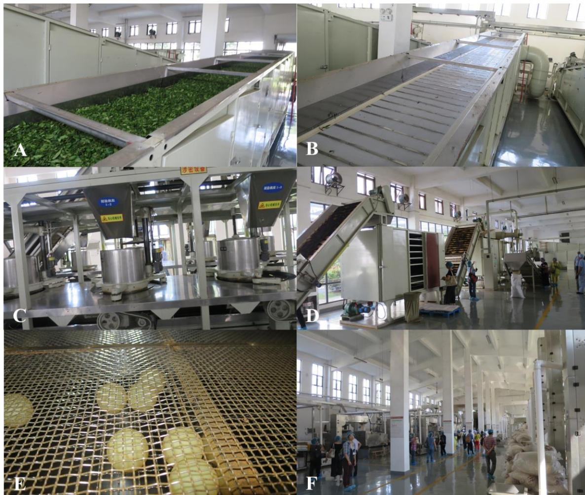
圖一、祁門紅茶製茶示範工廠－祁門紅茶初製生產流程。(A)連續式紅茶萎凋裝置(有茶菁)：使鮮葉散失一些水分，使葉梗由硬變軟，以方便揉捻。同時萎凋的過程中，鮮葉內部的酶會發生一連串的化學反應；(B)連續式紅茶萎凋裝置(無茶菁)；(C)連續式紅茶揉捻裝置：破碎葉細胞使茶汁溢出，增進色香味濃度，揉成景系美觀的外觀；(D)連續式紅茶回潤機械：紅茶第一次經過甲種乾燥機後，葉表面乾燥，但是葉中心沒乾燥，需要靜置等待葉中心水散失到葉表面；(E)茶葉抖篩裝置部分圖：篩網會不停的搖擺，使較小的茶葉被篩掉。裝置內部裝球目的是，篩網搖擺的過程中，球會撞擊網子造成振動，提高篩分的效率；(F)工廠內部。
