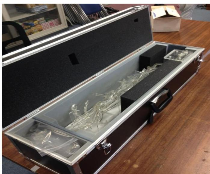
圖25：研究測試用血管模型
