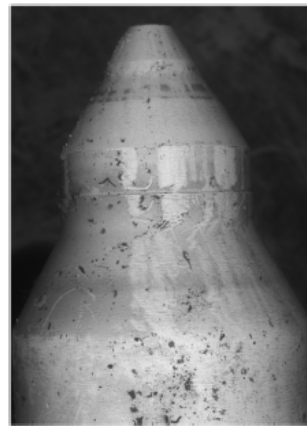
圖 30 單酸潤滑性添加劑 + Sodium -2-ethylhexanoate 對噴嘴產生積污，有羧酸鈉成份
