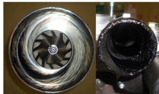
圖 11 有積污的渦輪壓縮機：左為擴散器，右為壓縮機出口
