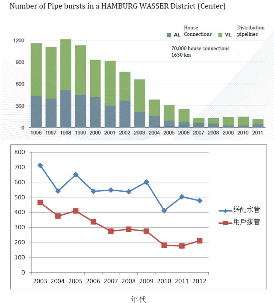
圖 28 漢堡水務中心區域(Centre District-上圖)及全區(下圖)自來水破管次數演進過程
