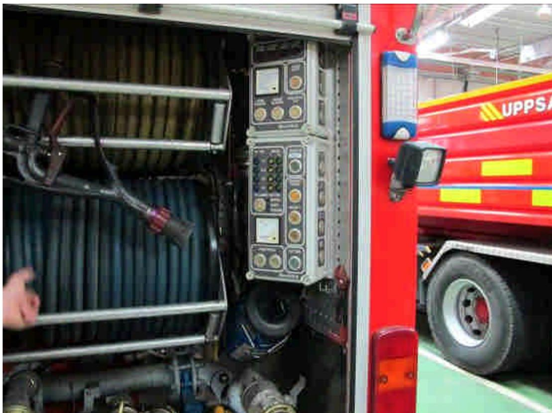
圖 6-18 水箱車上具備高低壓系統（高壓軟管壓力可達 50bar）
