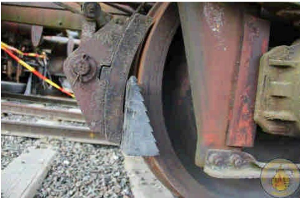
圖 4-8-3 使用墊塊置於煞車片與車輪間
