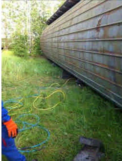
圖 4-7-6 墊塊鎖固車體
