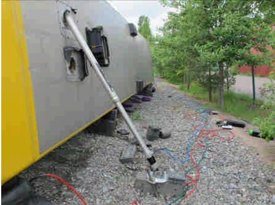
圖 2-4 使用氣動式支撐桿及墊塊組鎖固重型車輛
