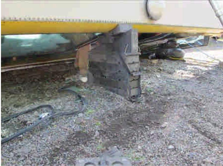
圖 4-5-10 塞入墊塊以達雙重確保的效果
