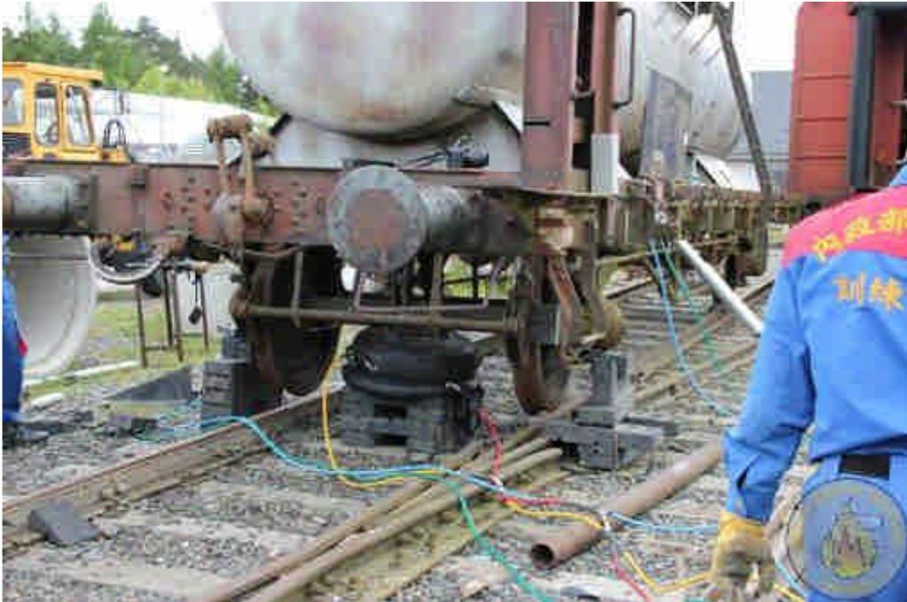
圖 4-8-8 頂昇定位後，利用氣動支撐桿及墊塊雙重鎖固
