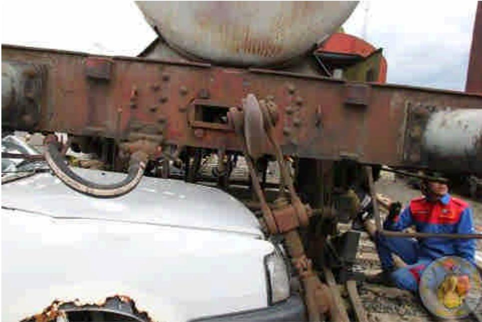
圖 4-8-4 追撞小客車施力於火車，增加頂昇時側移風險
