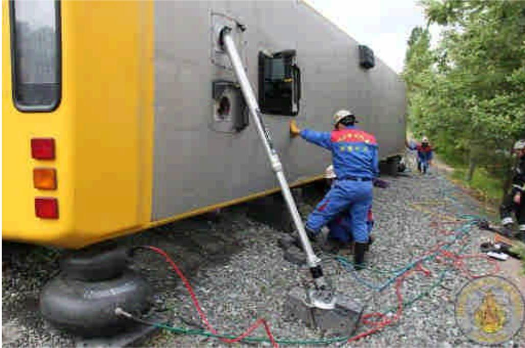
圖 4-2-10 頂昇至定位（以墊塊作鎖固車體之器具）
