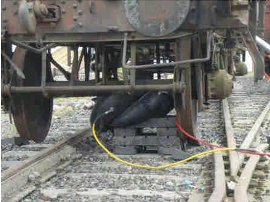
圖 4-8-9 車體降下時側邊施力未平均，造成系統嚴重偏移、火車脫軌
