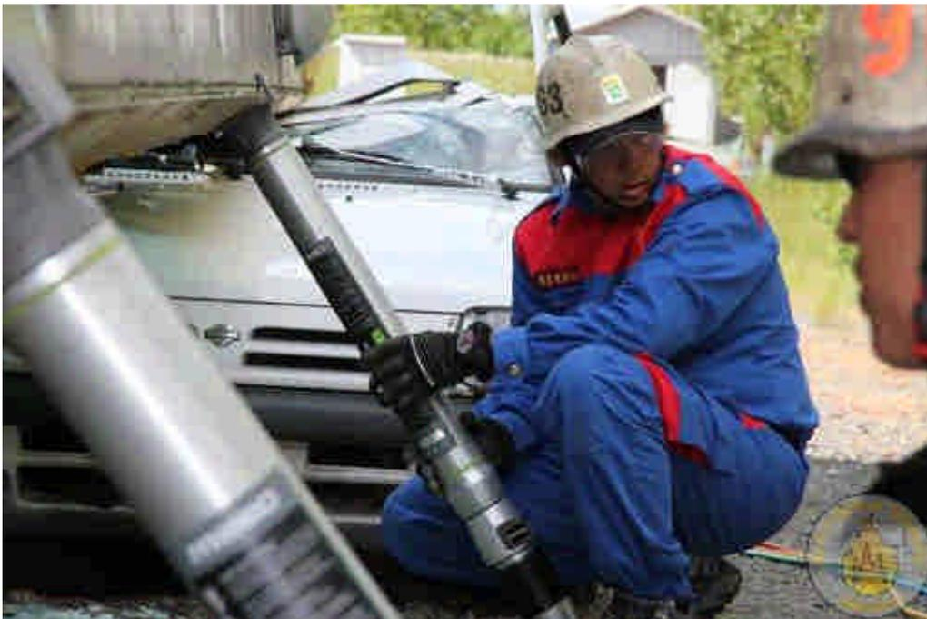
圖 4-5-3 支撐柱的鎖固動作
