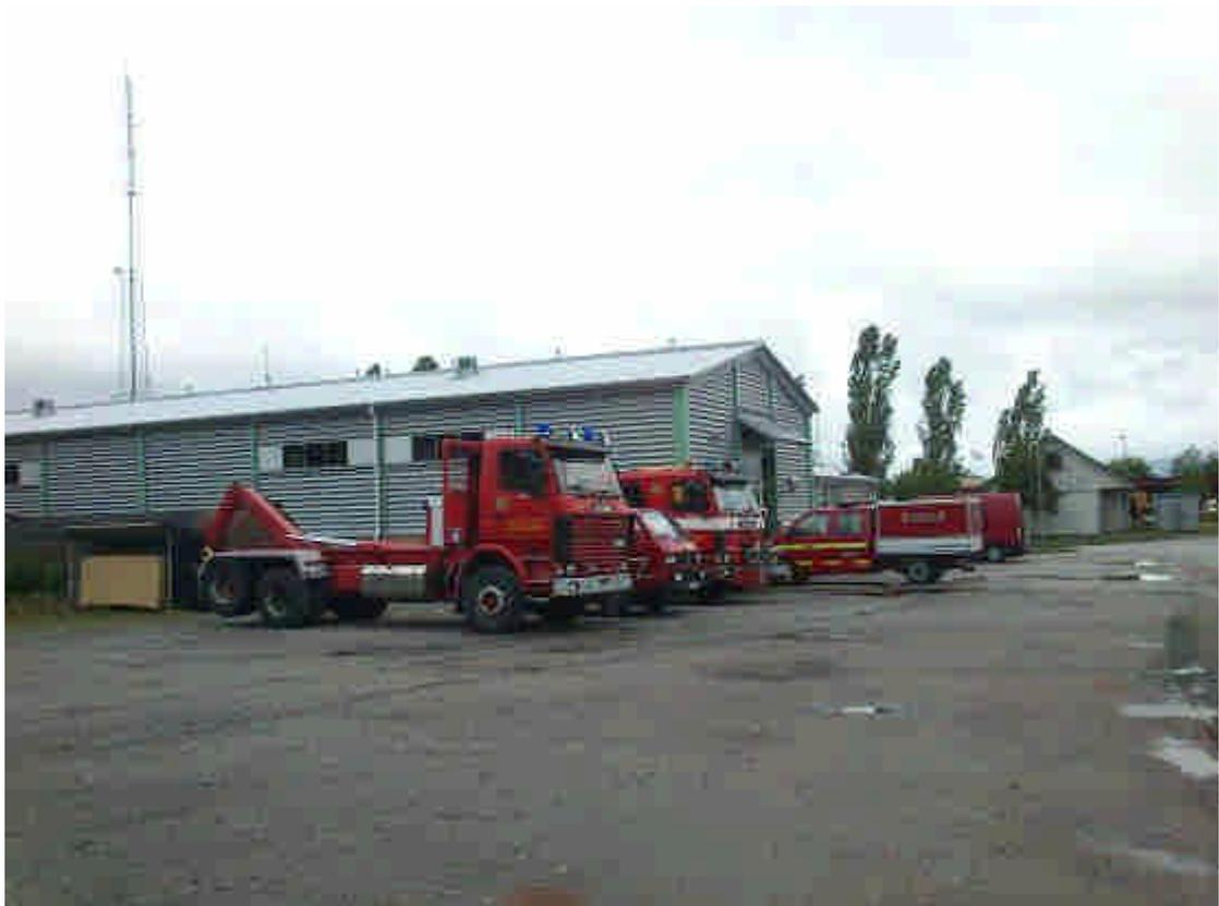
圖 6-12 與水箱分離後的車頭（可聯結不同的設備）
