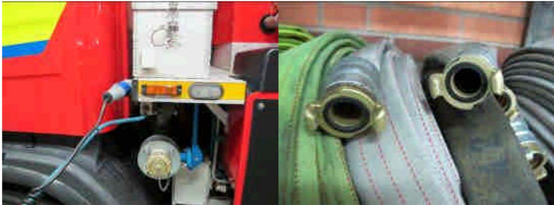
圖 6-13 車輛都可連接電源線可供無線電充電 圖 6-14 水帶接頭與台灣的不同
