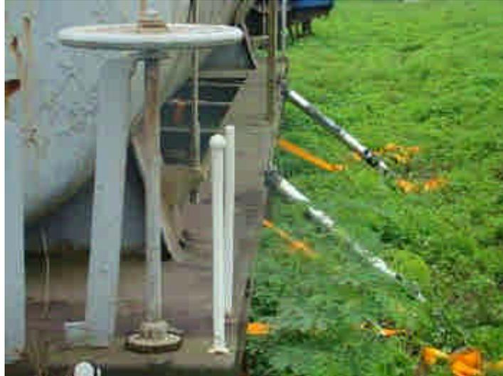
圖 7-8 結合緊固帶與支撐柱穩固車體
