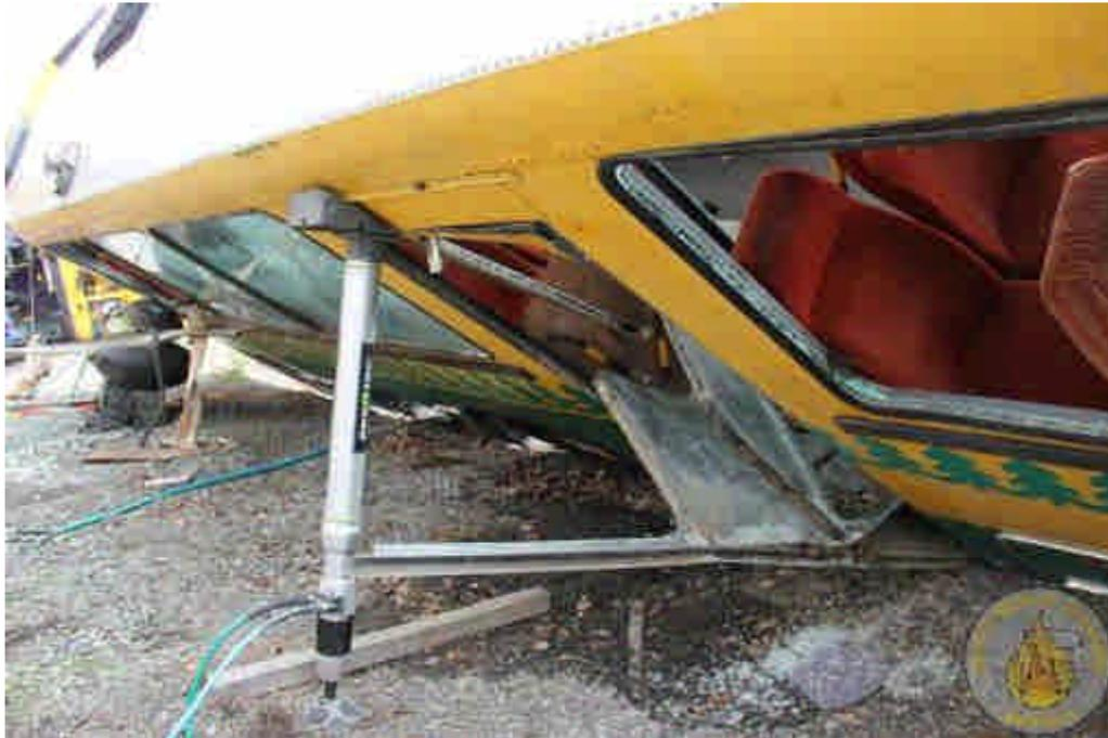
圖 4-5-7 跟隨負載的支撐柱作動情形
