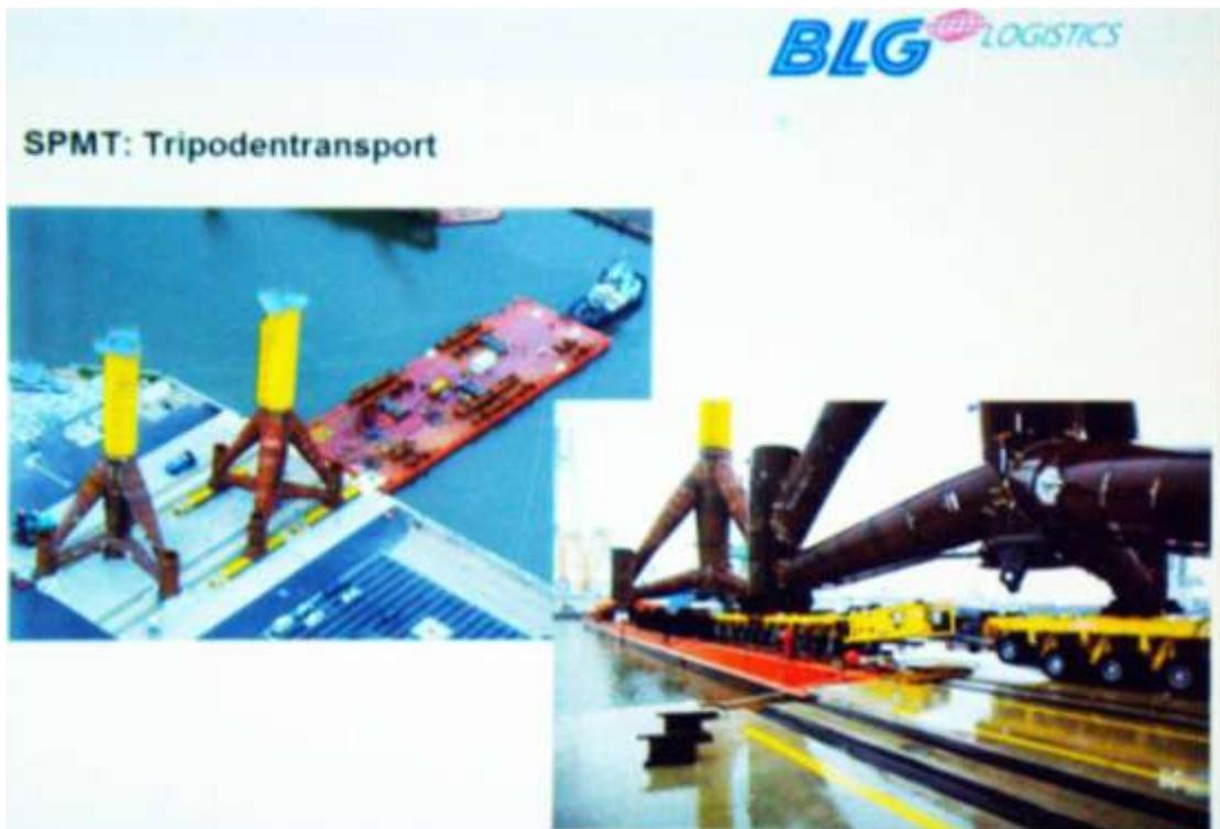
圖 20、BLG Logistics 研討會簡報展示以軌道及特製推車運送 tripod 基礎
