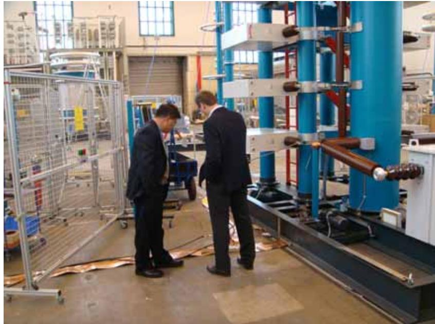
圖 3.26：「高電壓試驗及量度法」之移動式接地元件
