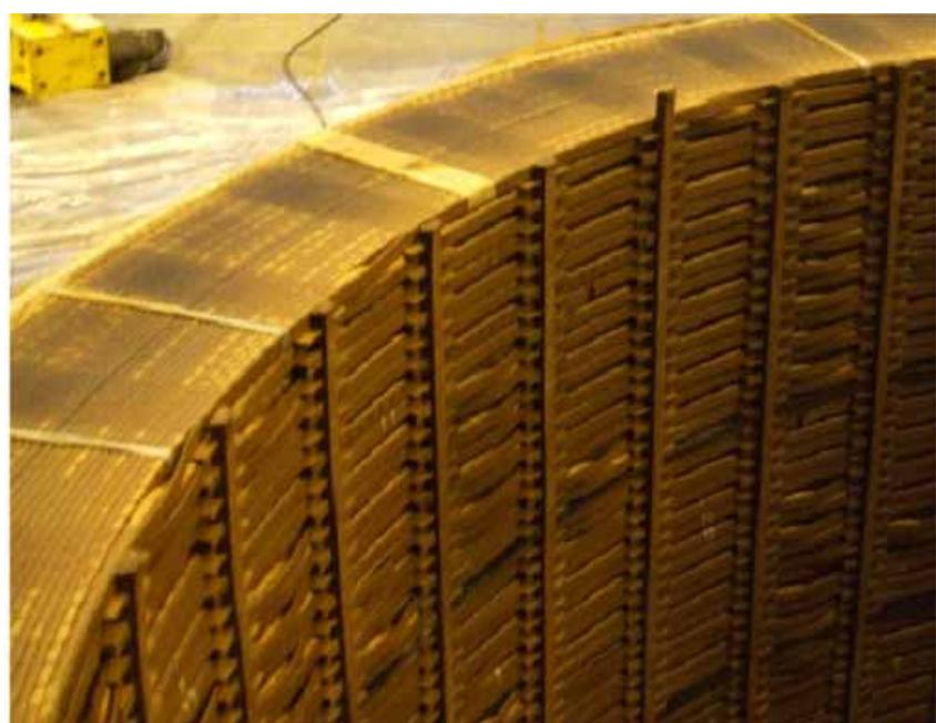
圖 3.31:浸油變壓器線圈腐蝕狀態
