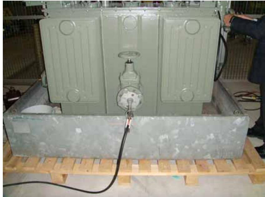
圖 3.9:超高頻傳感器耦合檢測應用(正視圖)
