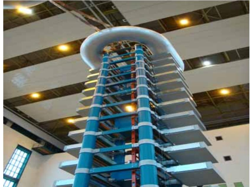
圖 3.28：「高電壓試驗及量度法」之移動式檢測元件配置結構
