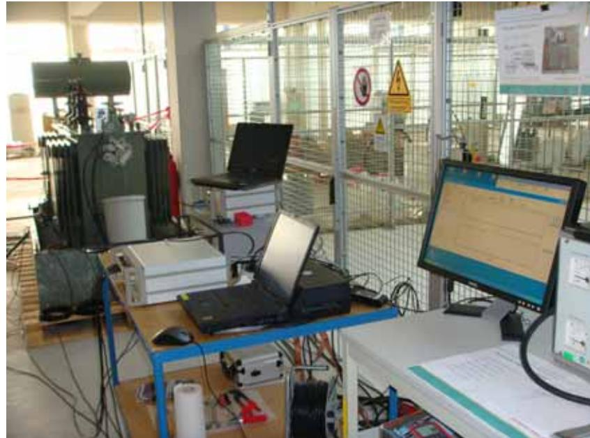
圖 3.7:超音波/超高頻傳感器耦合量測
