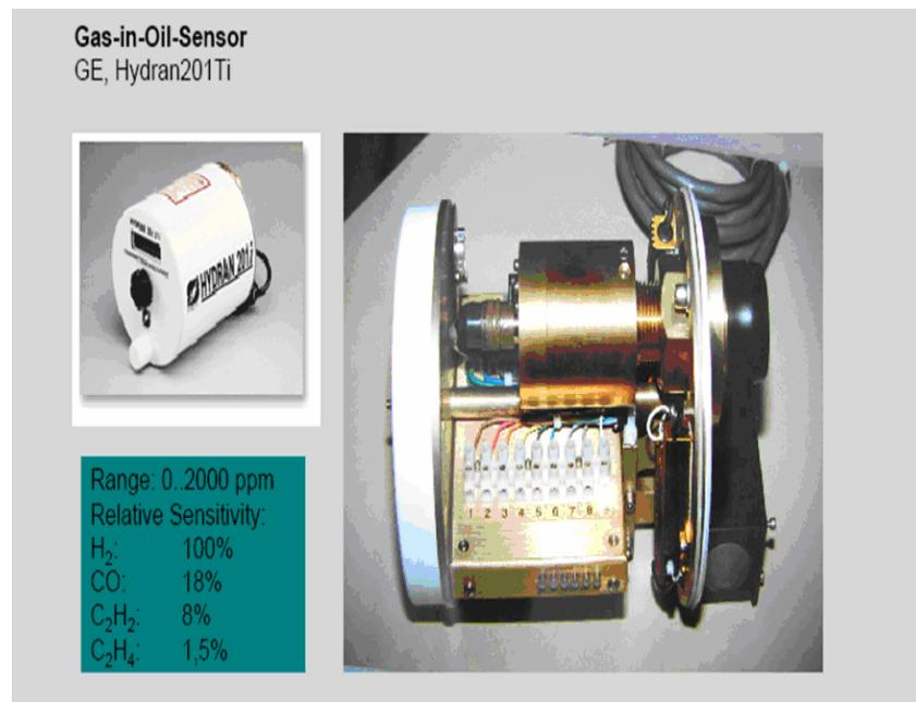
圖 3.18: 「變壓器資產管理技術」之油中氣體含量檢測器
