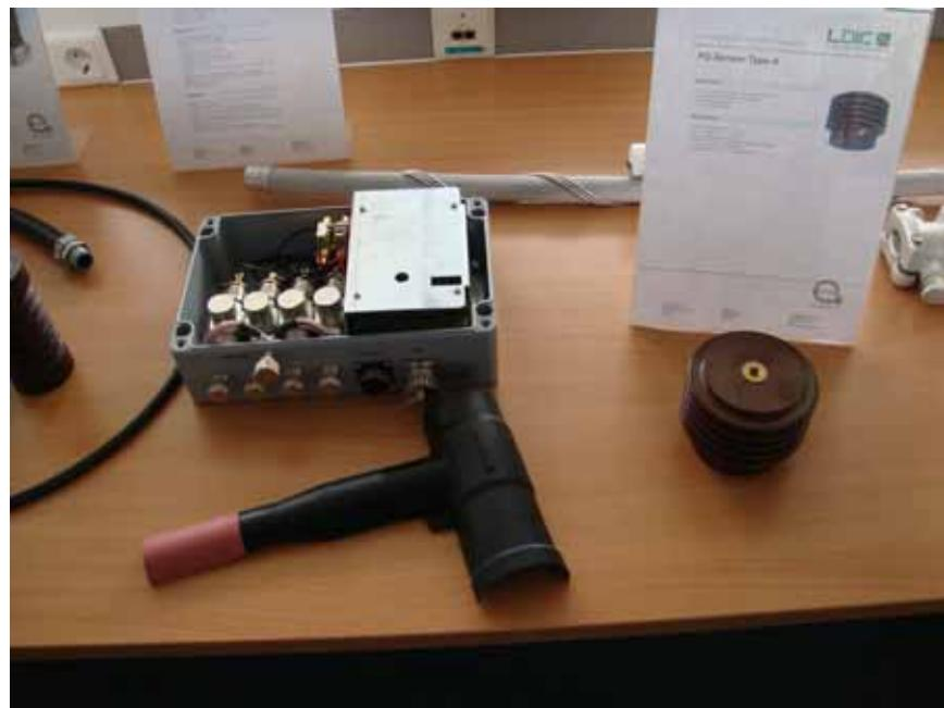
圖 3.4:電容套管分接頭傳感器
