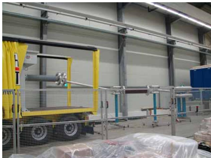
圖 3.23：「高電壓試驗及量度法」之移動式檢測設備連接配置
