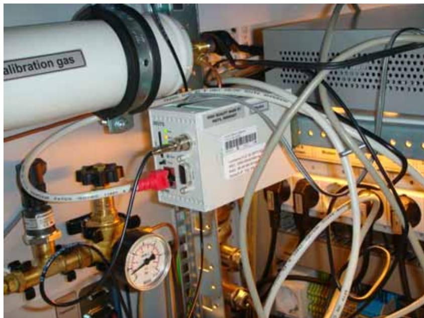
圖 3.33:油中氣體分析儀內部結構
