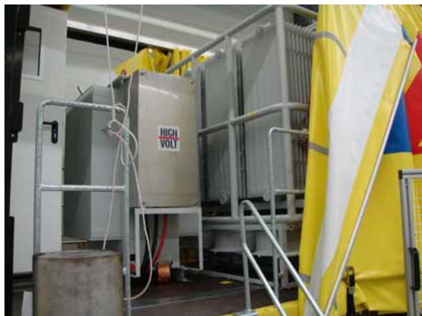
圖 3.24：「高電壓試驗及量度法」之移動式檢測設備控制配置
