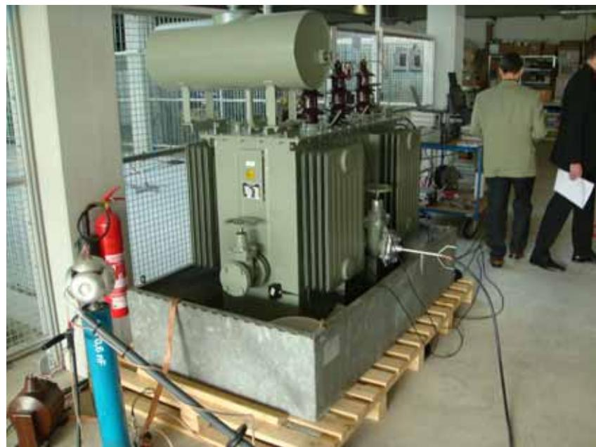
圖 3.8:超高頻傳感器耦合檢測應用(側視圖)
