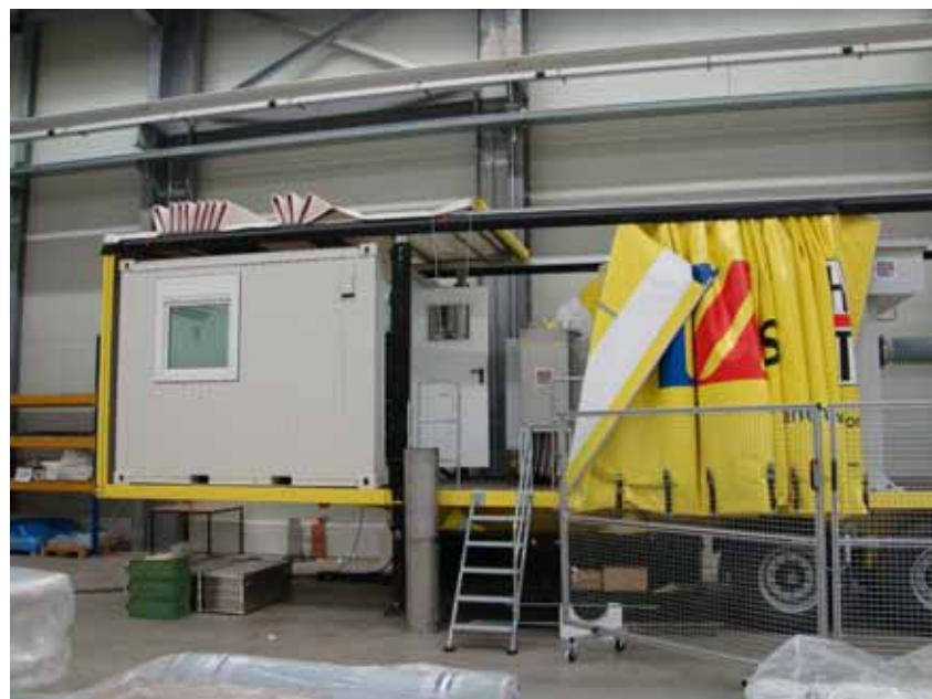
圖 3.21：「高電壓試驗及量度法」之移動式檢測設備(正視圖)
